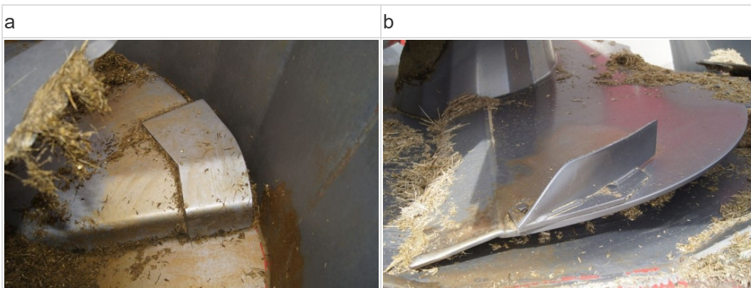
Figur 1. Eksempler på eftermonterede hjælpeforanstaltninger med det formål at sikre flowet i foderblanderne under blanding af kompakte rationer. Figur 1a viser effekt-plade monteret på Kongskilde (JF-Stoll) og Figur 1b viser snegleskær på BVL blander.
